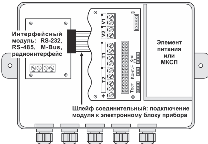
Рисунок Б.4 – Установка интерфейсных модулей в вычислитель KAPAT-306
